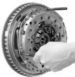
Abb. 11: Kupplungs-Druckplatte, Kupplungs-Scheibe abnehmen.
