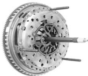
Abb. 10: Kupplungs-Zentrierwerkzeug, Gewindebolzen entfernen.
