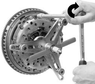
Abb. 24: Rändelmuttern, Kupplungs-Vorspanngerät und Gewindebolzen entfernen.
